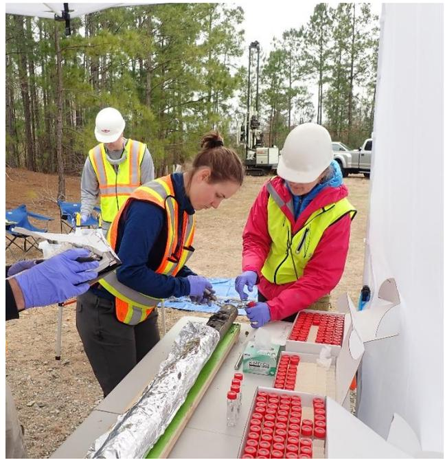
**Abbildung 2: Feststoffprobenahme aus Bohrkern**
